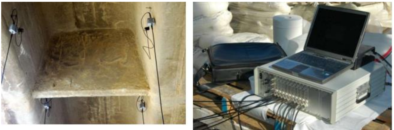
Figura 2.11: (a sx) endoscopi posizionati negli appositi fori e collegati (a dx) ad opportuno strumento di lettura (preso da [4])
