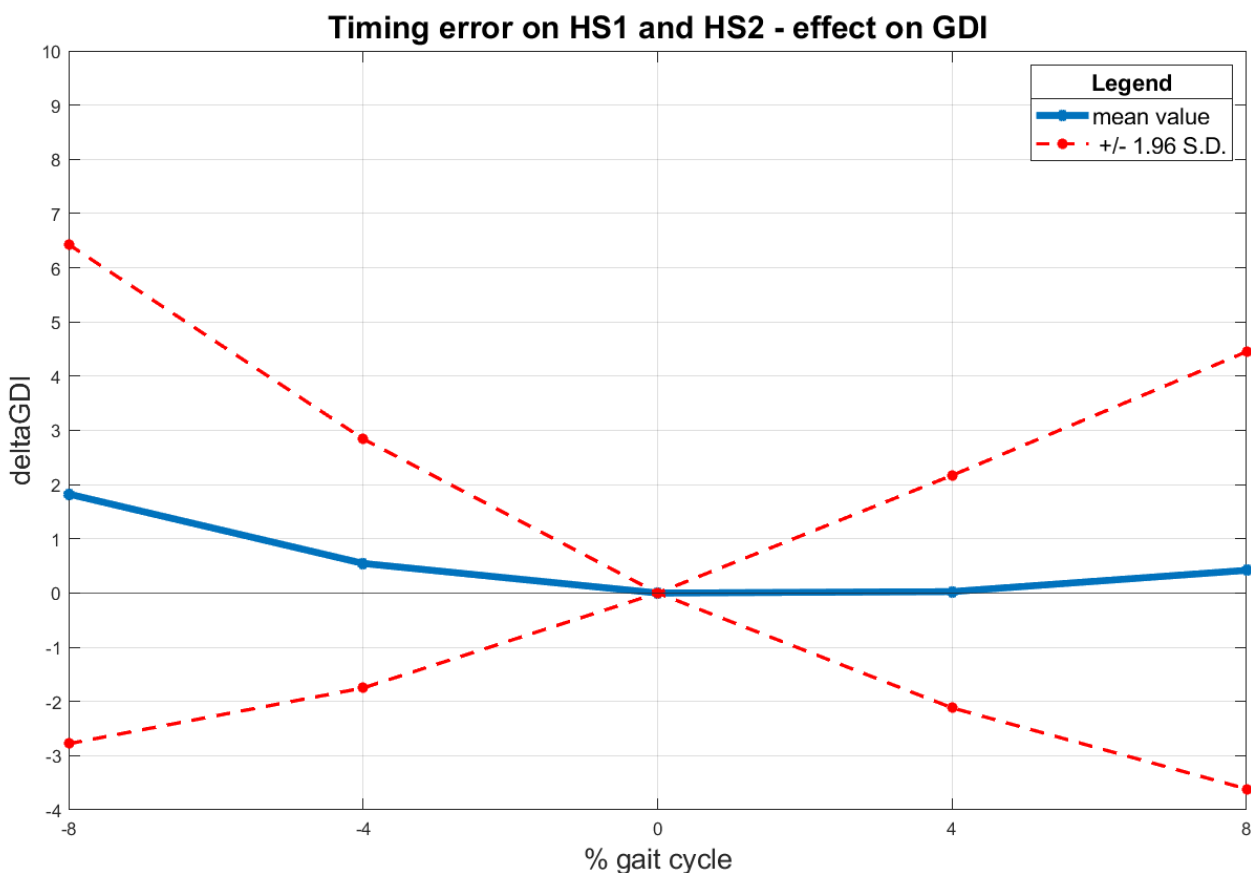
Figura 3.15. Effetto sul calcolo del GDI dell'errore di timing sul primo e sul secondo istante di appoggio del tallone (HS1 e HS2). Nel grafico è rappresentato il valor medio dell'errore assoluto ( GDI - GDI^* ) in funzione di un errore che varia tra il -4\% e il +4\% del gait cycle. Inoltre, viene rappresentato anche l'intervallo di confidenza al 95%.
