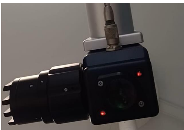
Figura 3.20: 2 led rossi per collimazione.
