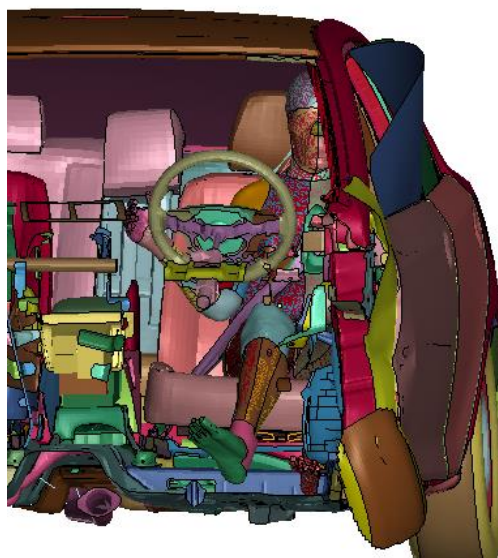
Figura 61 – Impatto FS inclinato all'istante t=96ms
