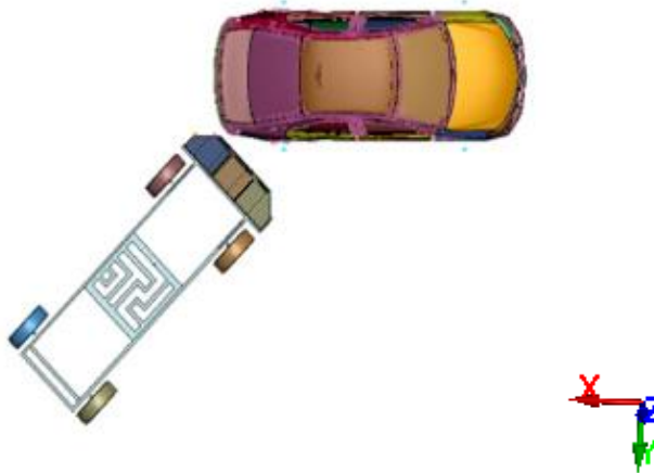
Figura 25 – Impatto posteriore destro
