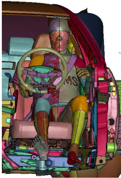
Figura 60 - Impatto PS Inclinato all'istante t=88ms
