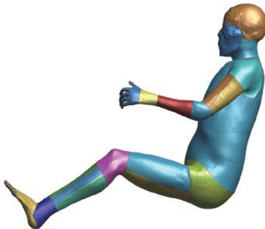
Figura 13 - Modello seduto del THUMS (TOYOTA MOTOR CORPORATION, 2015)
