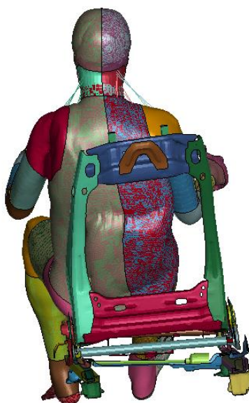
Figura 93 – Impatto PS con dettaglio della struttura del sedile a 87ms
