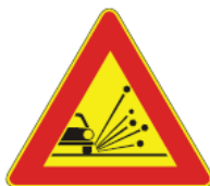
Figura 1.3: Segnale di Materiale instabile sulla strada
