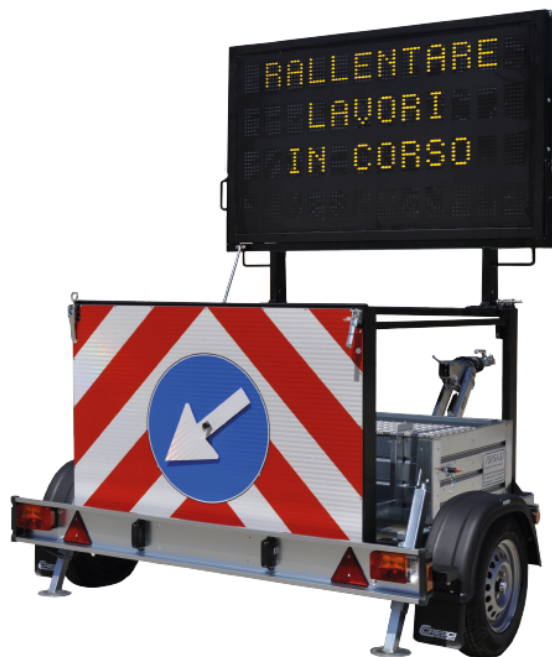
Figura 2.4: Pannelli a messaggio variabile temporanei - Sisas Spa
