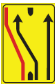
Figura 1.7: Segnale di chiusura corsie
