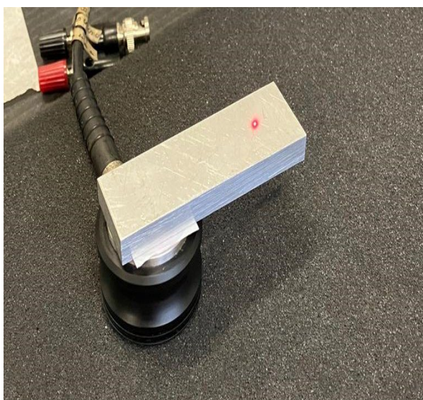
Figura 4.15. Set-up con trasduttore e laser su facce opposte del campione (dettaglio della prova eseguita sul campione C).
