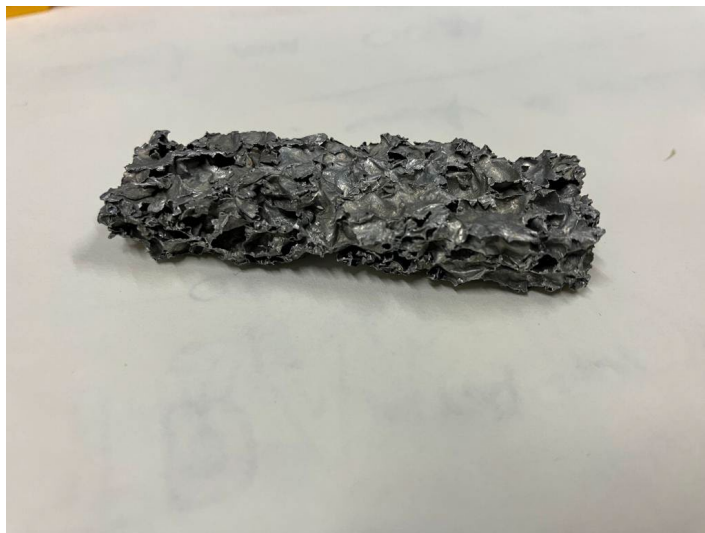
Figura 1.12. Campione costituito da sola schiuma per prove vibrazionali.
