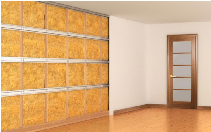
Figura 2.5. Materiali porosi per assorbimento acustico [5].
