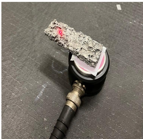
Figura 4.14. Set-up con trasduttore e laser su facce opposte del campione (dettaglio della prova eseguita sul campione A).
