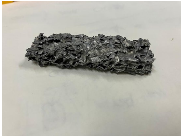
Figura 1.11. Campione di sandwich utilizzato per misure di diffusività termica.
