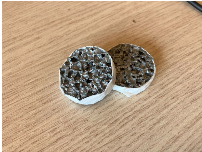
Figura 1.10. Campioni di schiuma di alluminio per prove acustiche.
