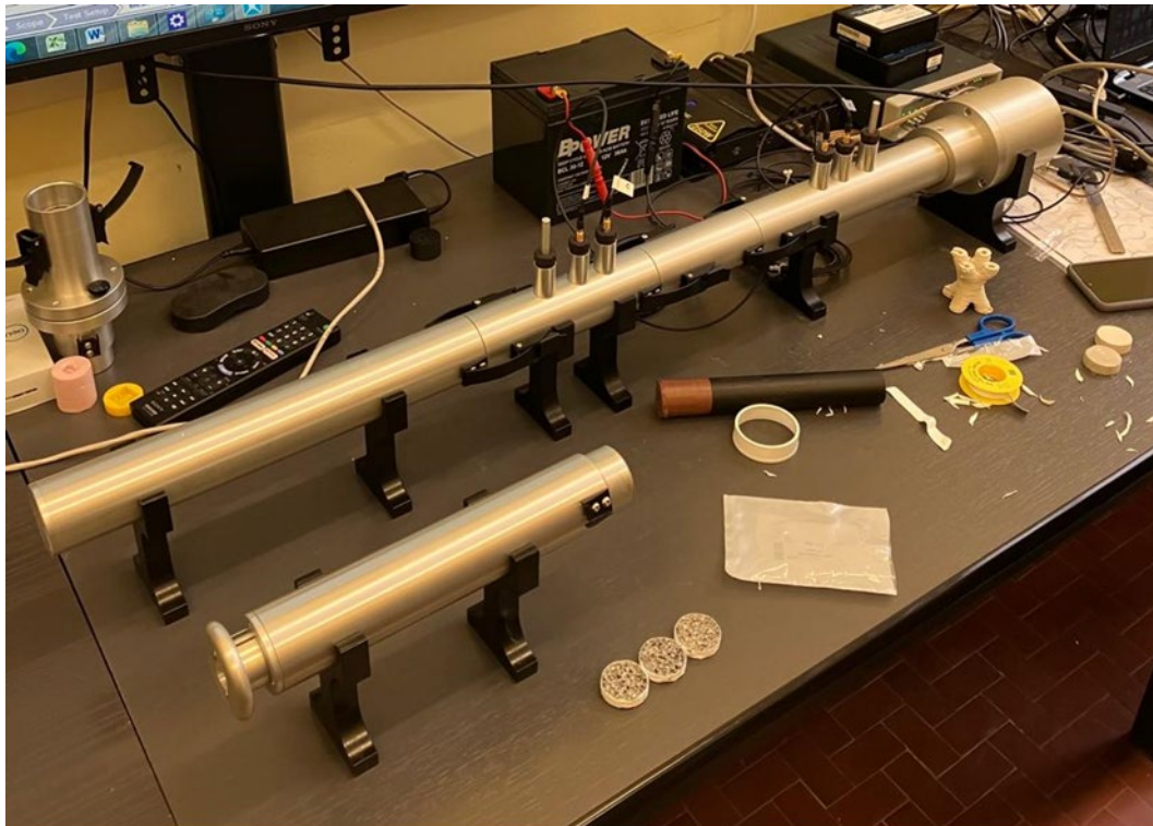
Figura 2.26. Tubo di Kundt o di impedenza impiegato per le analisi sperimentali.
