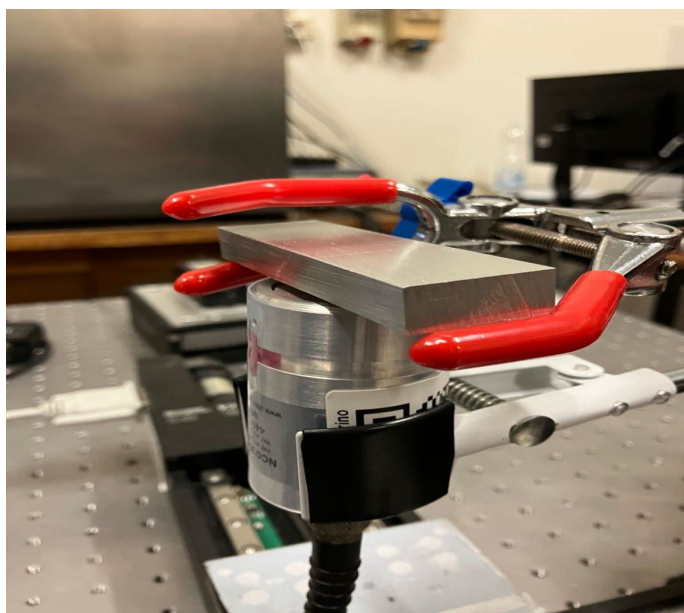
Figura 1.13. Campione di alluminio bulk per prove vibrazionali.
