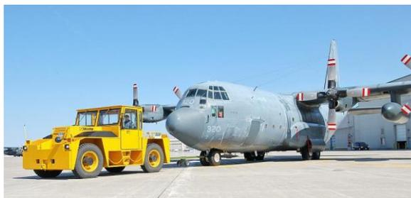
Figura 14 Pushback di un C130-J<sup>12</sup>
