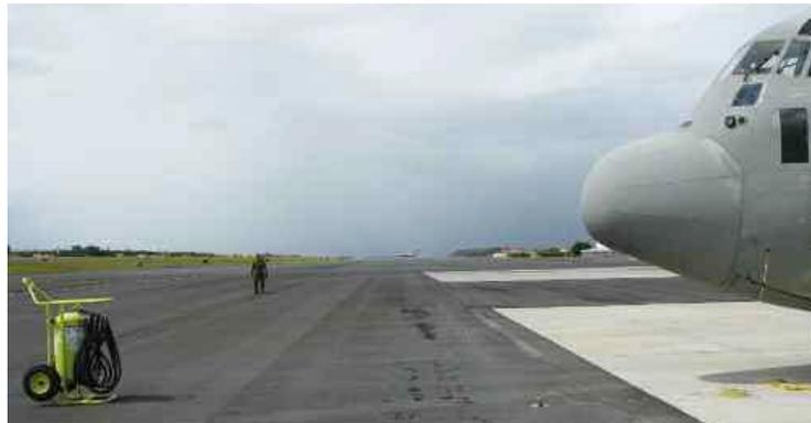
Figura 10 Posizionamento estintore rispetto al C130-J<sup>10</sup>
