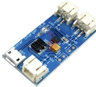
Figure 35: Mini Solar Charger (CN306518650 Li-Ion Mini Solar Charger Module, 2023)
