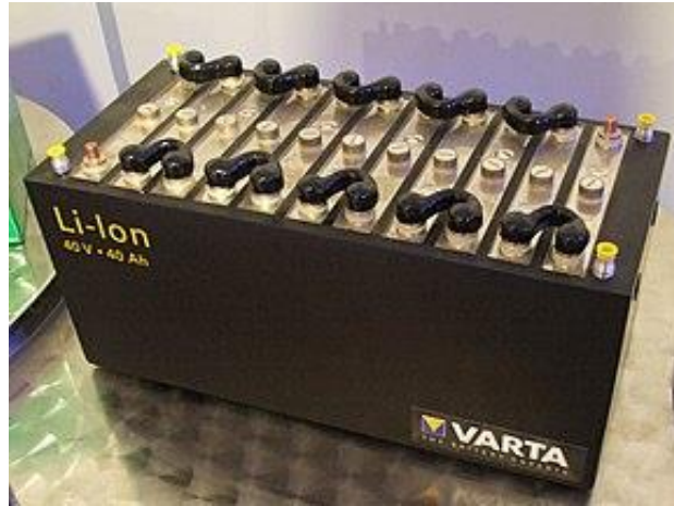
Figura 79: Esempio di Batteria agli ioni di litio
