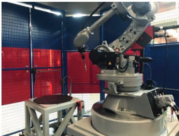
Figura 6 - Cella Mandelli automatizzata per l' additive manufacturing [9]
