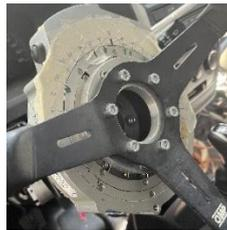
Figure 43 - Segni di riferimento per angolo volante
