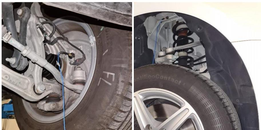
Figure 90 - Accelerometri mozzo (sinistra) e duomo (destra)
