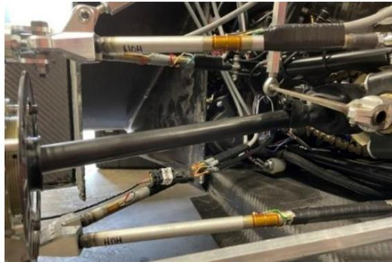
Figure 29 - Sensore di forze sul tirante dello sterzo
