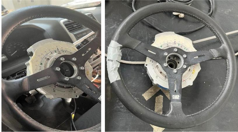
Figure 21 - Sensore di coppia volante ed angolo volante Type 2
