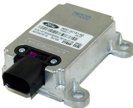
Figure 24 - Sensore di accelerazione laterale
