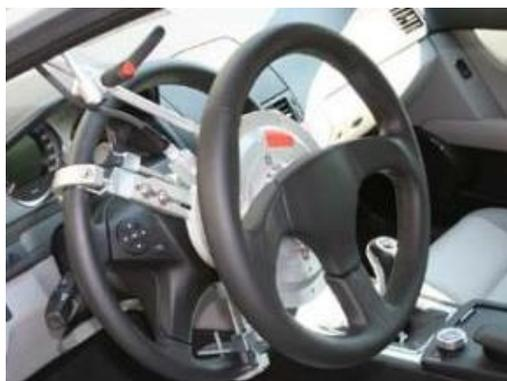
Figure 20 - Sensore di coppia volante ed angolo volante Type 1
