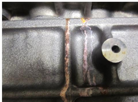
Figura 6.42. Perdite di liquido refrigerante
