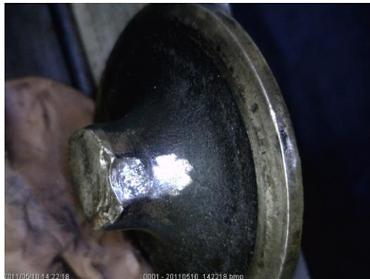
Figura 6.33. Valvola rotta causa bridge rotato
