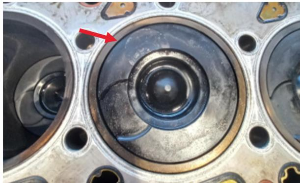
Figura 8.39. Impatto tra le valvole di scarico e il pistone
