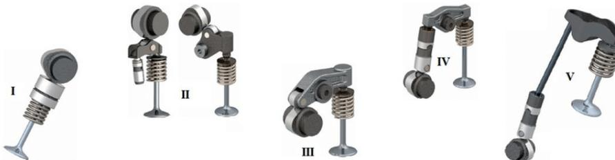
Figura 2.5. Tipologie di valve train [5]
