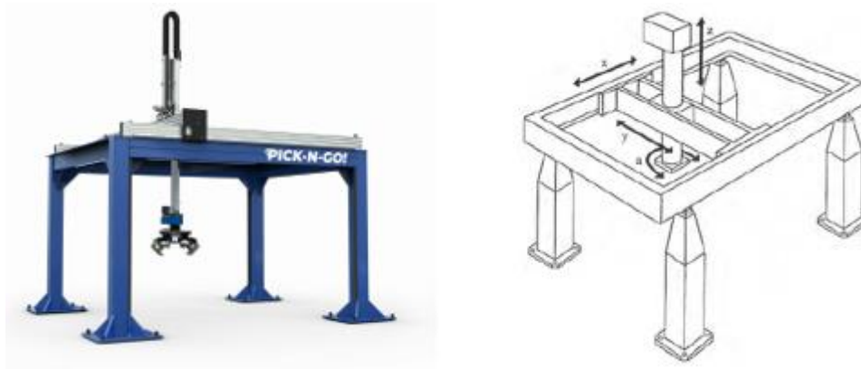
Figura 40 - Struttura a portale (sx) e schema con il relativo sistema di coordinate (dx)
