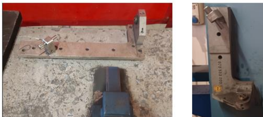
Figura 107 – Calibro raddrizzatore sul banco di lavoro per il robot 1 (sx) e sulla via di corsa per il robot 3 (dx)
