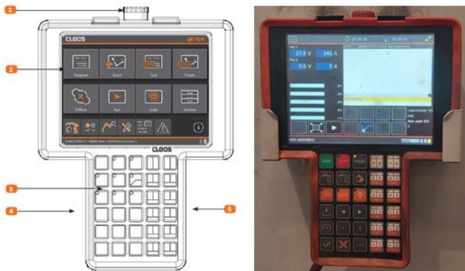
Figura 70 - Schema (sx) e fotografia scattata in stabilimento (dx) della pulsantiera di programmazione
