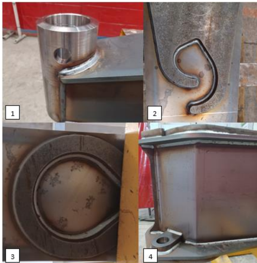
Figura 109 - Tratti di saldatura perfezionati
