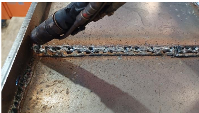
Figura 31 - Aspetto tipico di una saldatura soffiata
