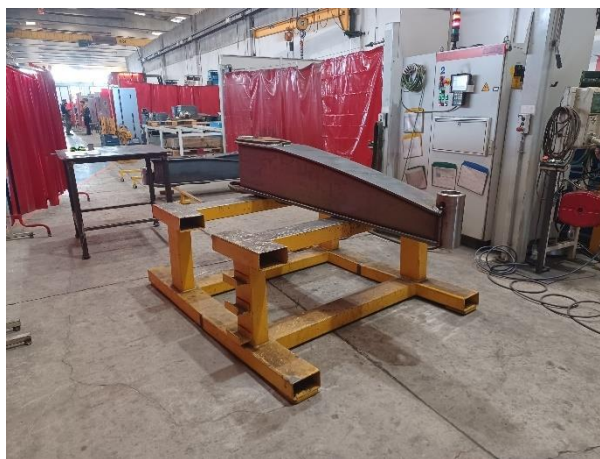
Figura 103 - Cavalletto esterno per le finiture
