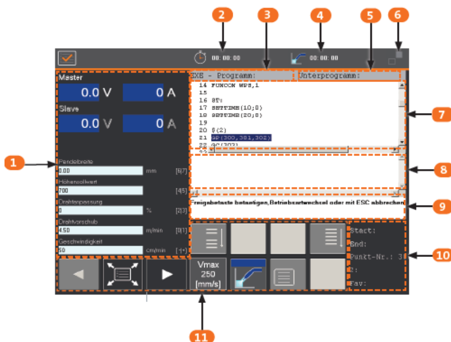
Figura 73 - Display touch screen per la saldatura in modalità "manuale"
