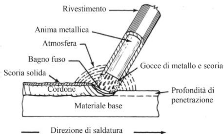
Figura 14 - Schema per la saldatura manuale ad elettrodo rivestito
