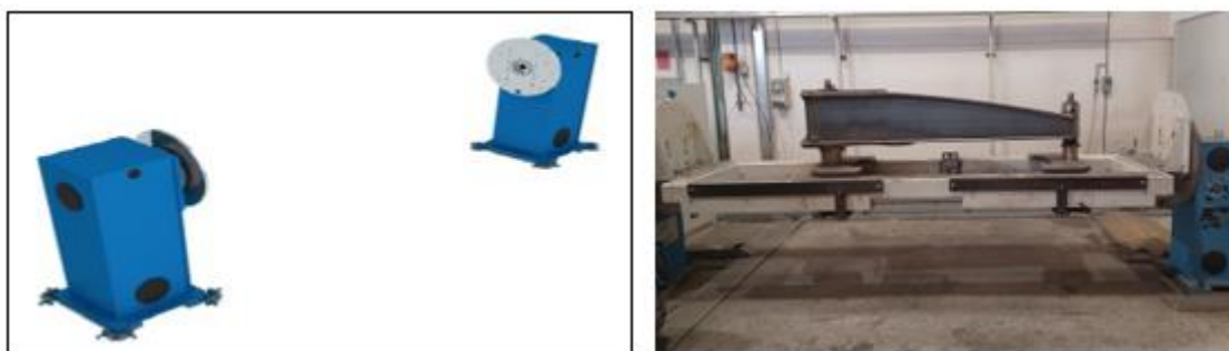
Figura 68 - Schema (sx) e fotografia scattata in stabilimento (dx) del posizionatore a tavola rotante
