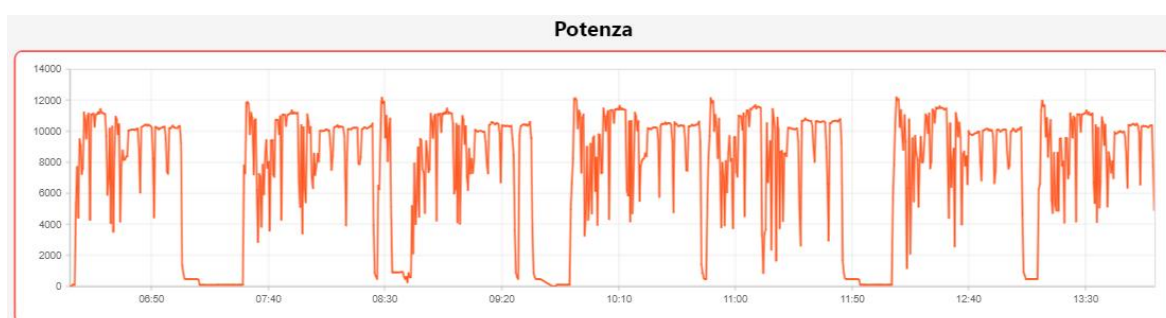
Figura 110 - Potenza dissipata per la saldatura di travi stabilizzatori Hup 40-30 il 14/06/2023 dalle 08:00 alle 14:00
