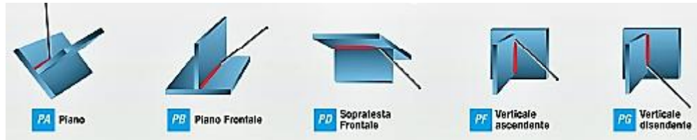
Figura 8 - Posizioni per saldatura ad angolo
