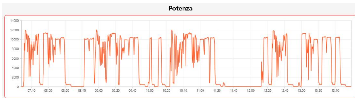
Figura 102 – Potenza dissipata per la saldatura di travi stabilizzatori Hup 40-30 il 29/05/2023 dalle 08:00 alle 14:00
