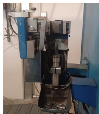
Figura 105 - Strumento adibito alla pulizia della punta del robot
