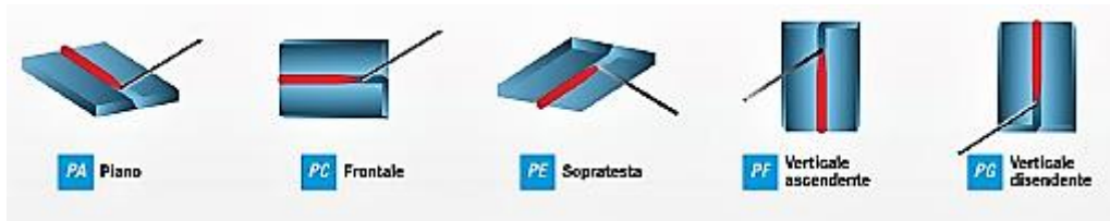
Figura 7 - Posizioni per saldatura di testa
