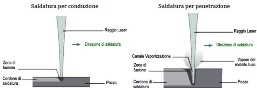
Figura 19 - Saldatura laser per conduzione (sx) e con foro di penetrazione (dx)
