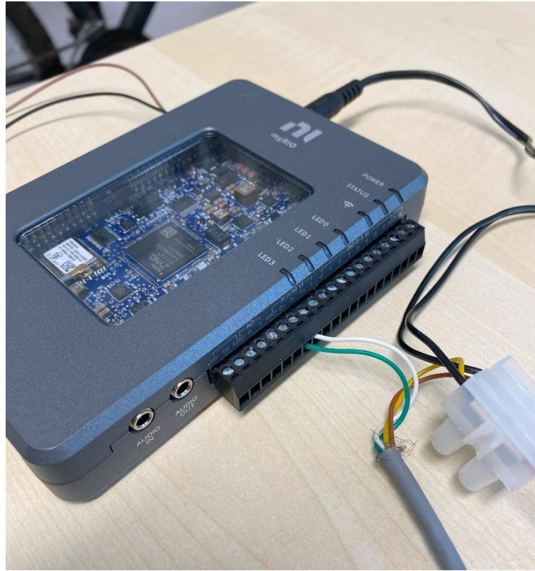
Fig 18. Collegamento tra amplificatore e myRIO
