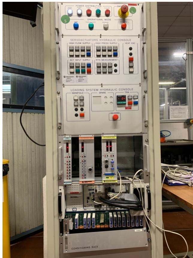
Figura 2 Armadio di controllo e acquisizione.
