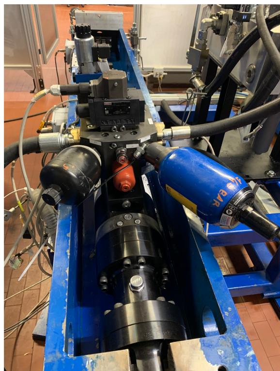
Figura 4 Sistema idraulico dell'attuatore di carico.
