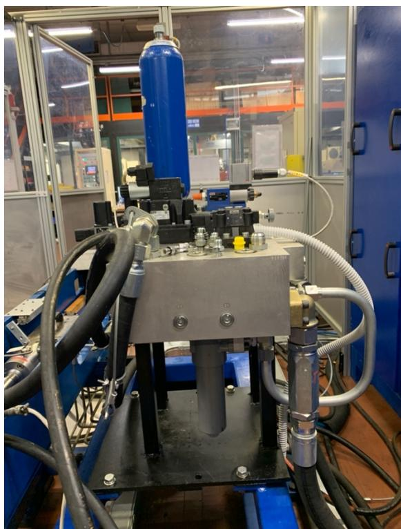
Figura 3 Manifold di regolazione del flusso.
