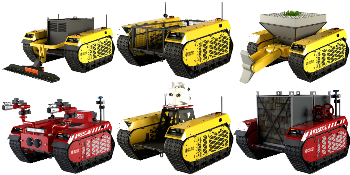
Figura 2.16: Esempio di veicolo modulare prodotto dalla Milrem Robotics [27]
