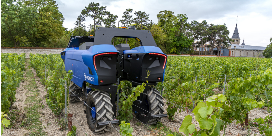
Figura 2.11: Rover Bakus durante un'operazione di sarchiatura su un vigneto [24]
