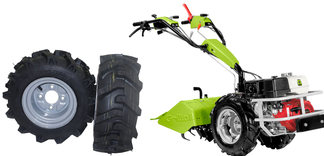
Figura 3.22: Esempio di motofresa Grillo con le relative ruote a lisca di pesce [42][43]
