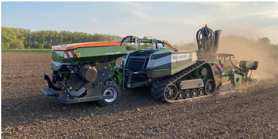
Figura 5.2: Esempio di rover autonomo prodotto dalla AgXeed [76]
