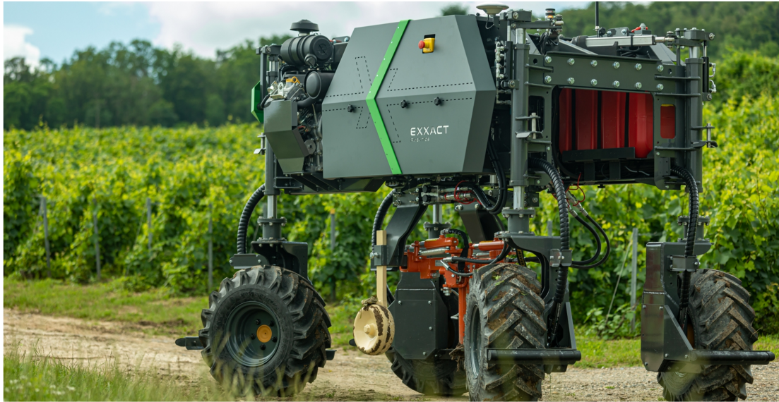
Figura 5.3: Esempio di rover con ruote indipendenti della Exxact Robotics [78]
