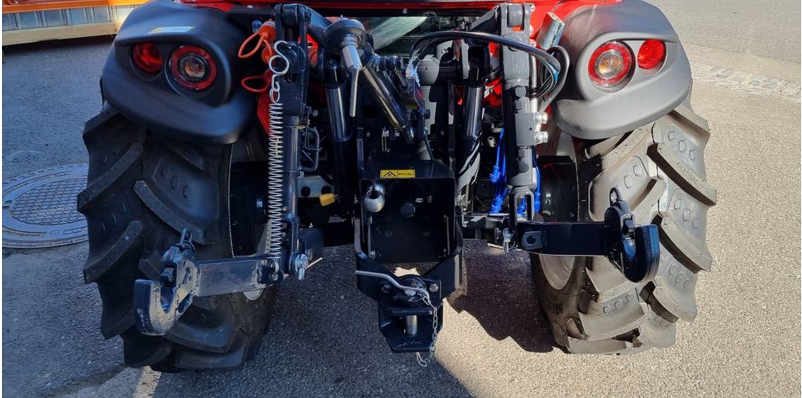
Figura 3.5: Esempio di trattore con attacco a tre punti e PTO [31]
