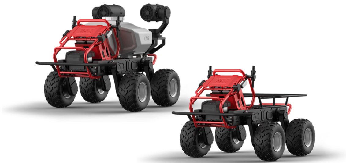
Figura 2.18: Esempio di rover modulare a quattro ruote fisse prodotto dalla cinese XAG [30]
