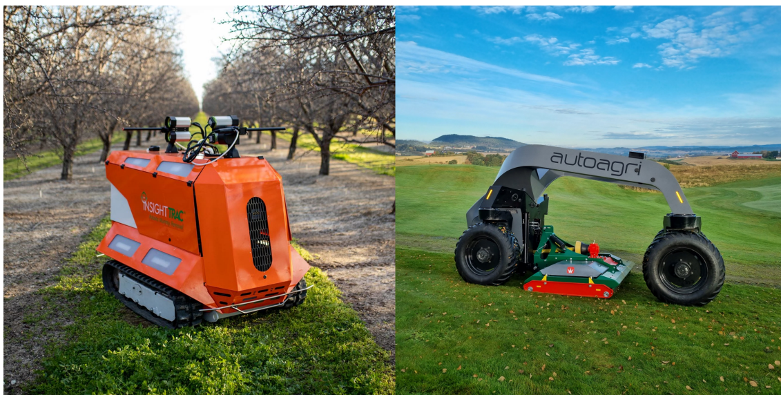
Figura 2.6: Esempio di un mezzo a singolo scopo, a sinistra, e di uno multiscopo, a destra [22][23]
