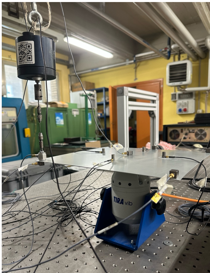
Figura 5.2: Dettaglio della piastra utilizzata per le misurazioni sperimentali
