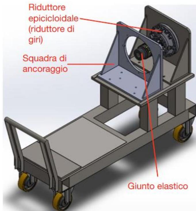
Figura 3.7: Modello CAD della configurazione base di un carrello mobile del banco prova
