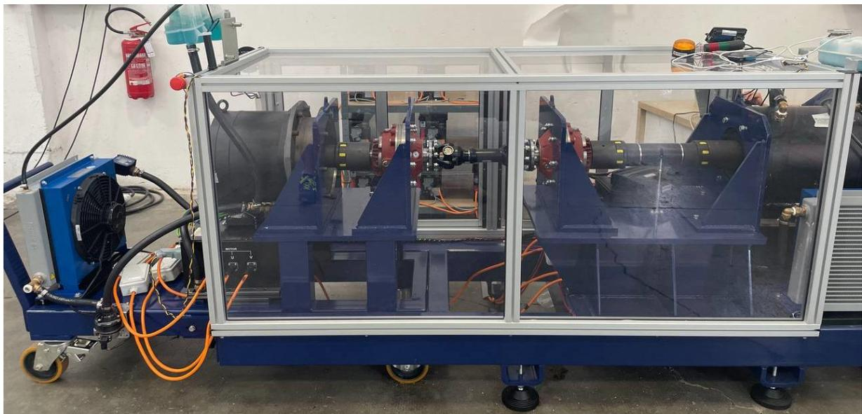
*Figura 3.17: Vista frontale completa del banco prova realizzato con motore sotto test accoppiato*
