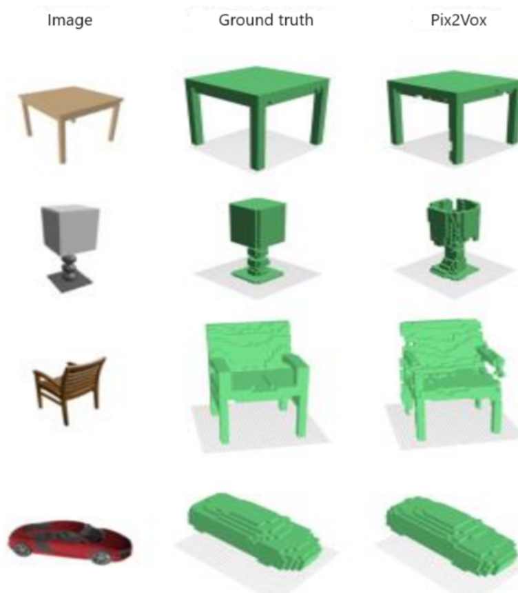
Figura 3.10: A partire dall'immagine in input, ricostruzione in formato voxel rispetto al modello di riferimento.
