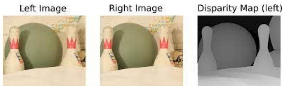
Figura 31: Esempio di disparity map calcolata in riferimento all'immagine di sinistra
