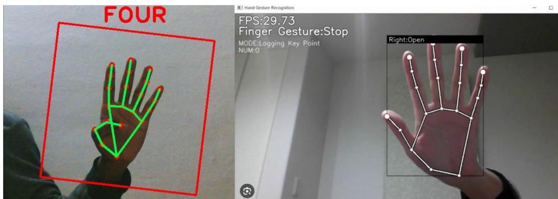
Figura 28: esempi di hand recognition sviluppato tramite la libreria OpenCV di Python.
