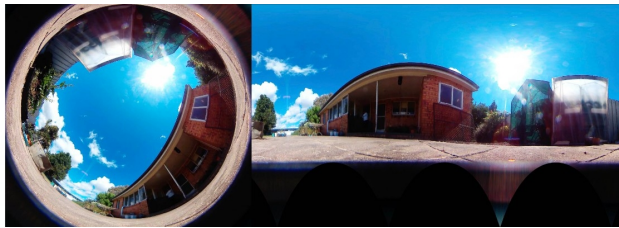
Figura 2.9: Visione fisheye (sx) e visione equirettangolare (dx)
