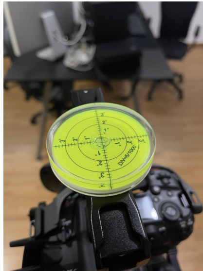
Figura 2.8: Livella per controllare l'inclinazione della camera VR 180° sul set de "I Nostri Sogni"
