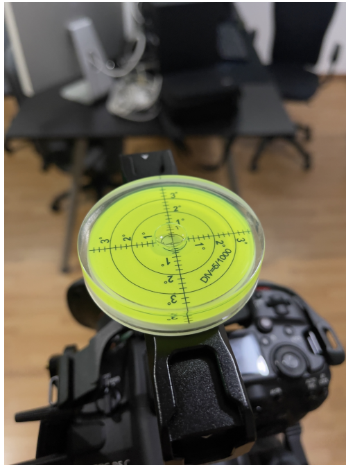
Figura 4.17: Bolla analogica montata sulla camera
