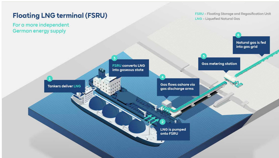
Figure 2.5 How a floating LNG terminal works [18].
