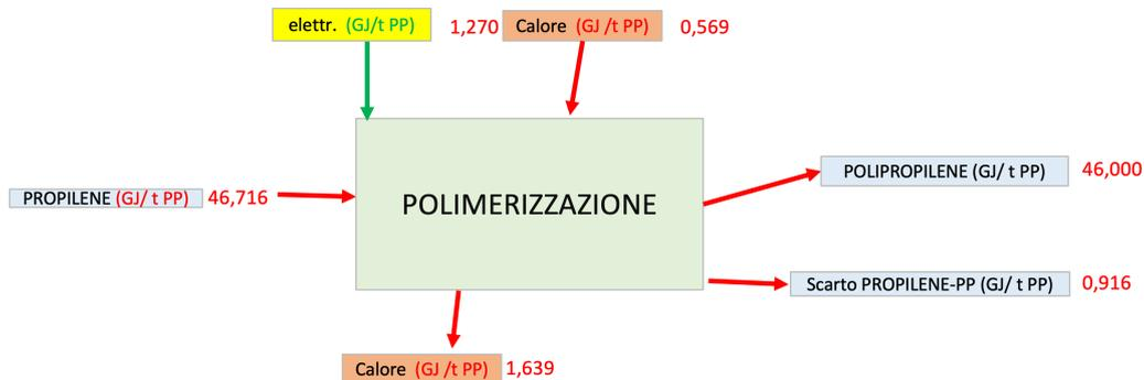
Figura 29: Schema bilancio energetico polimerizzazione polipropilene
