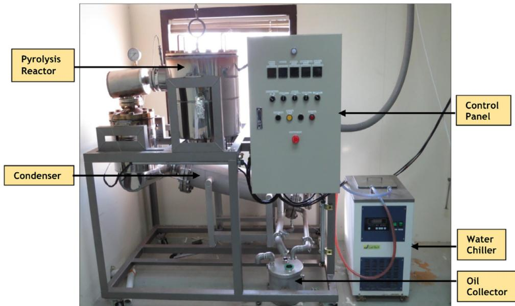
Figura 4: Impianto per la pirolisi scala laboratorio [16]
