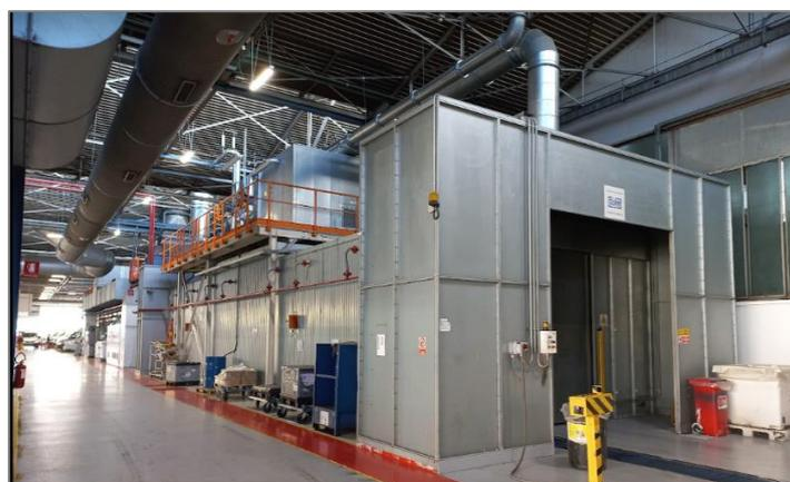
Figura 71: vista della cabina per spruzzatura e del forno per ritocchi in sequenza
