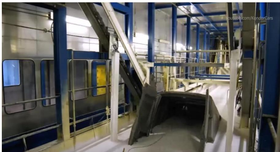
Figura 20: immersione della scocca nelle vasche presenti in reparto di verniciatura
