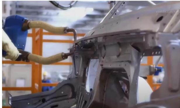
Figura 19: processo di saldatura a punti
