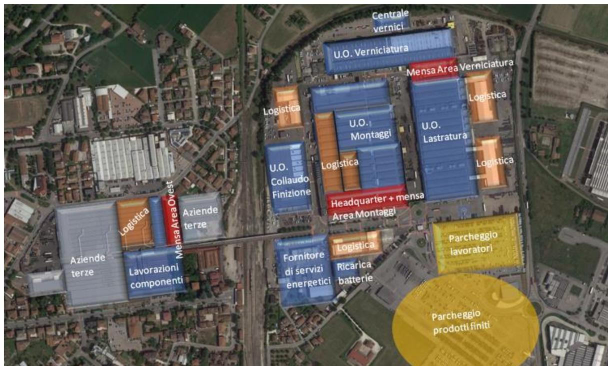
Figura 17: vista dall'alto dello stabilimento e indicazione dell'uso delle aree
