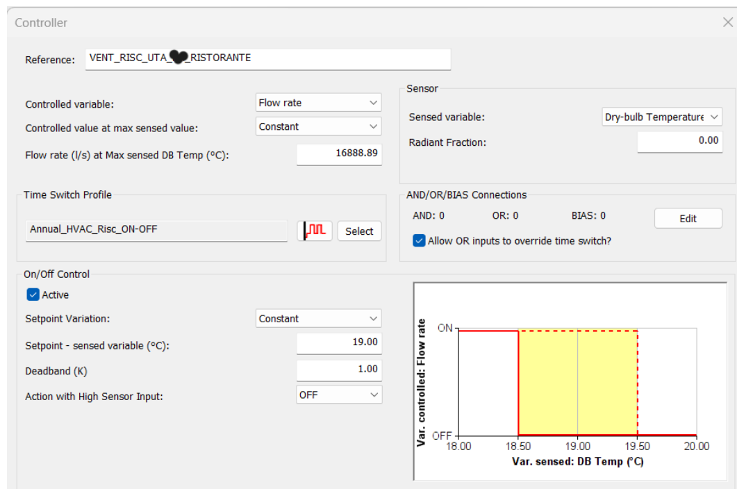
Figura 57 - Esempio di sistema di controllo e di attuazione della ventilazione nella configurazione nei mesi invernali
