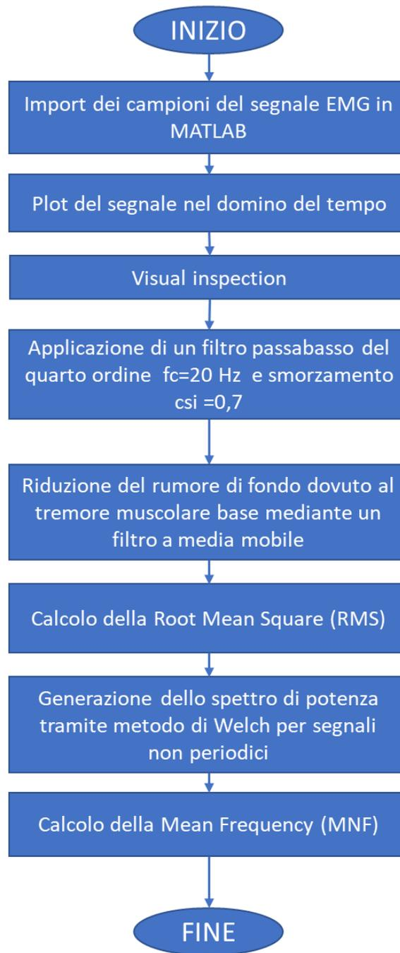
Figura 15: Diagramma di flusso dell'elaborazione del segnale di EMG
