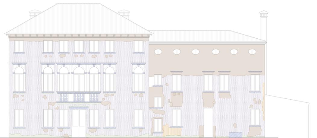
Fig. 129 Analisi dei degradi del prospetto sud del corpo nobile, scala 1:200
