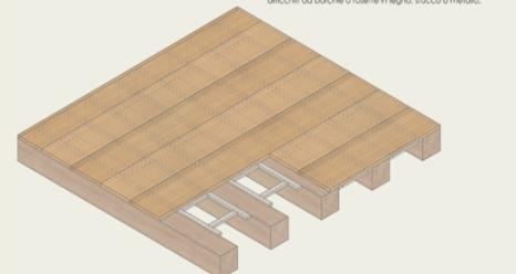
Schema isometrico solai tipo Varese - scala 1:20
