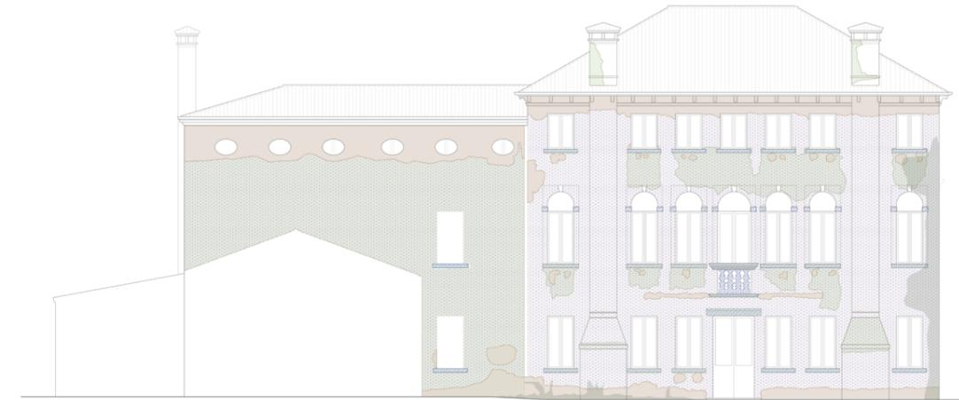
Fig. 125 Analisi dei degradi del prospetto nord del corpo nobile, scala 1:200
