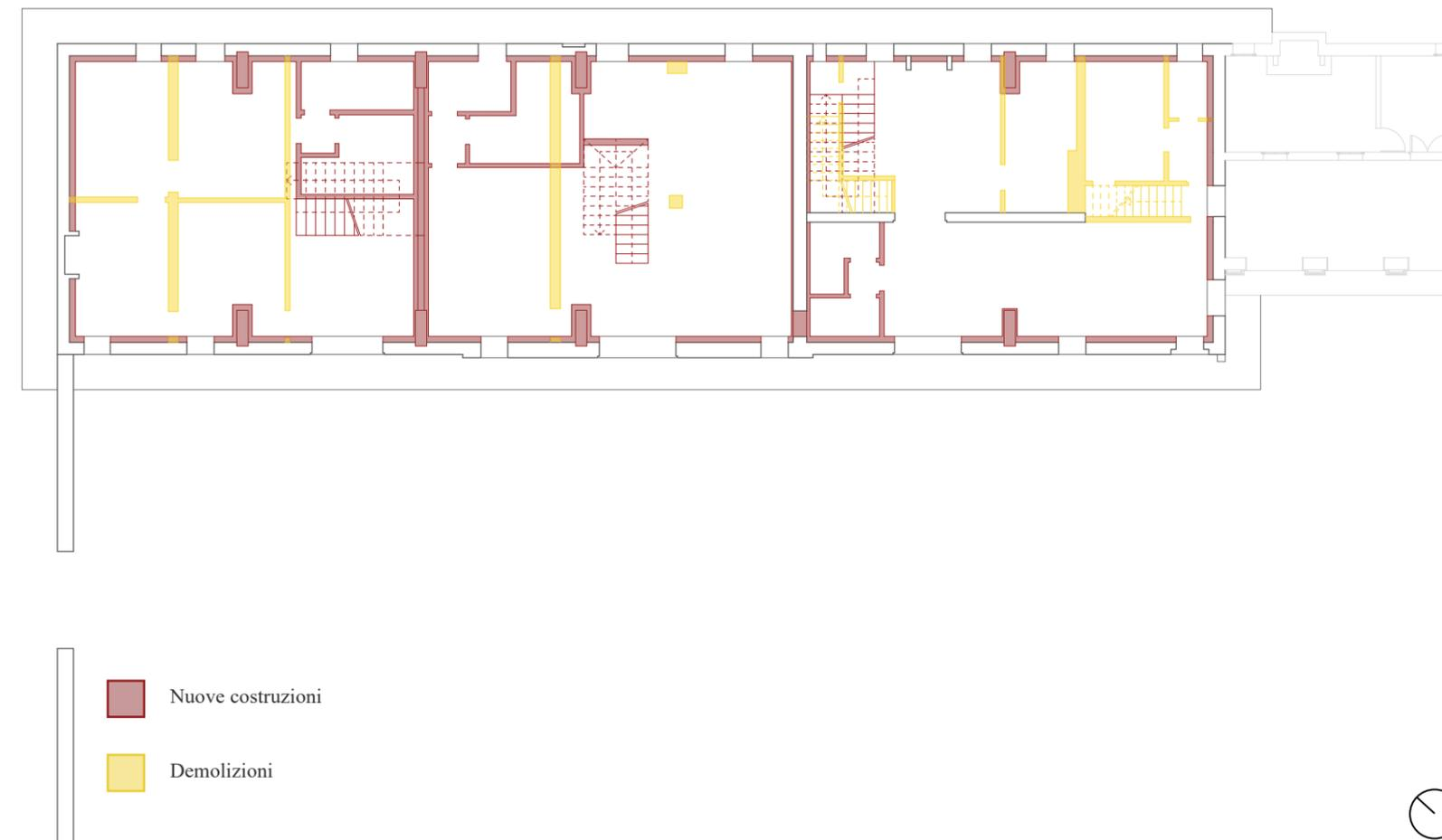
Fig. 139 Pianta con costruzioni e demolizioni, scala 1:200
