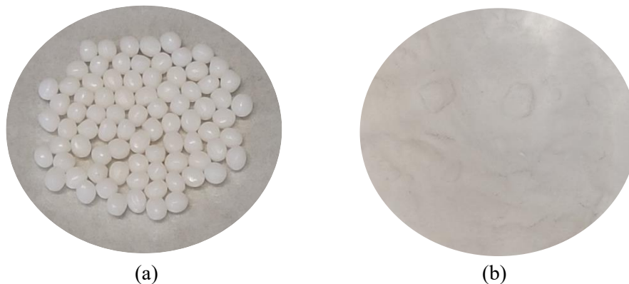
Figura 22: Immagini raffiguranti i pellet di PBAT (a) e la relativa polvere prodotta (b).
