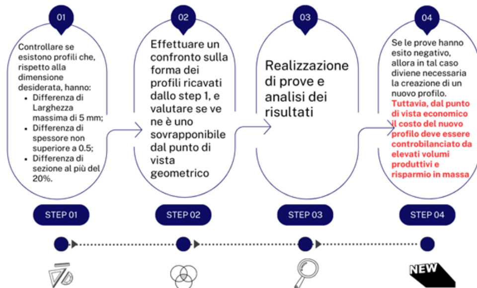
Figura 6.1: Linee guida ottimizzazione geometrie fianco esterno
