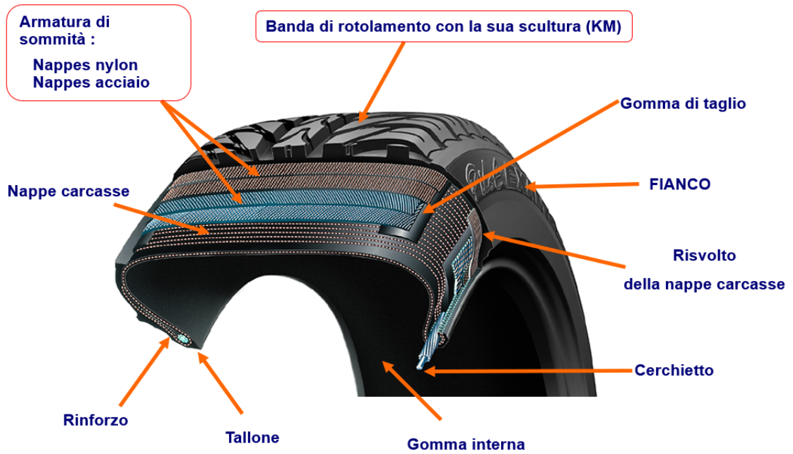
Figura 1.7: Struttura di uno pneumatico
