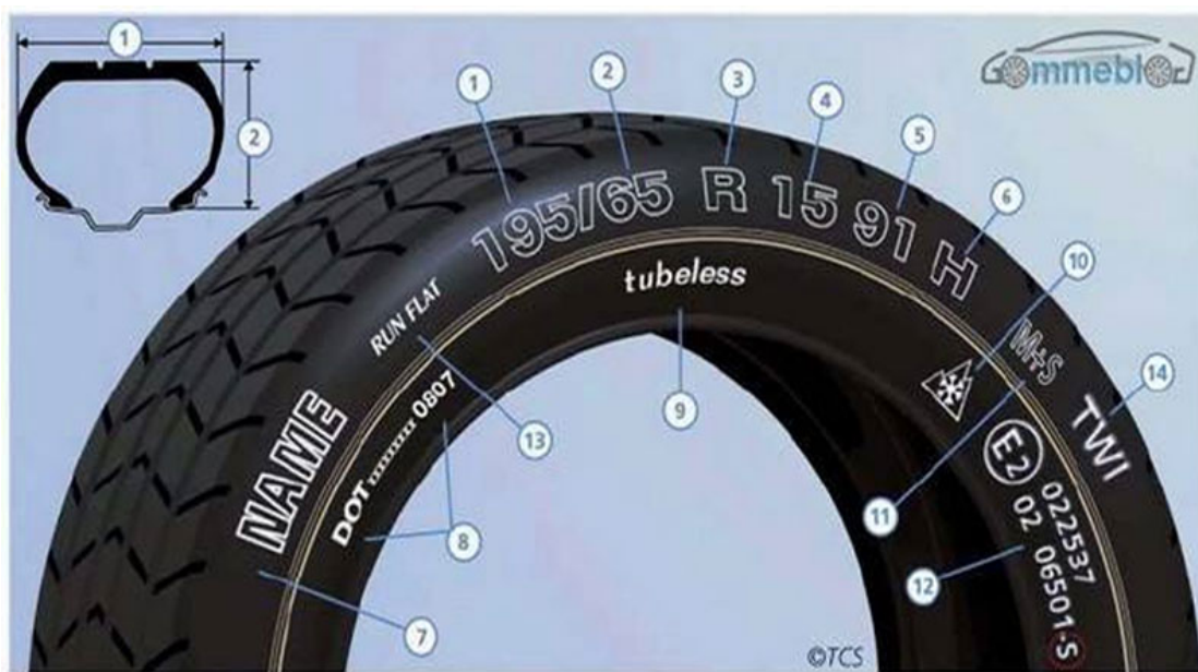
Figura 1.5: Nomenclatura di uno pneumatico
