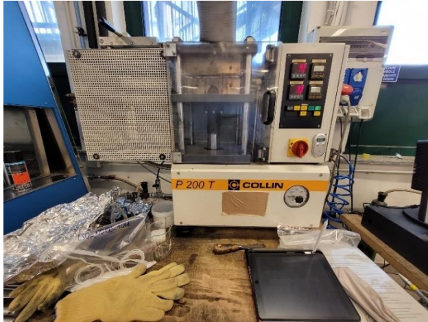
Figura 25 - Pressa a compressione Collin P 200T.
