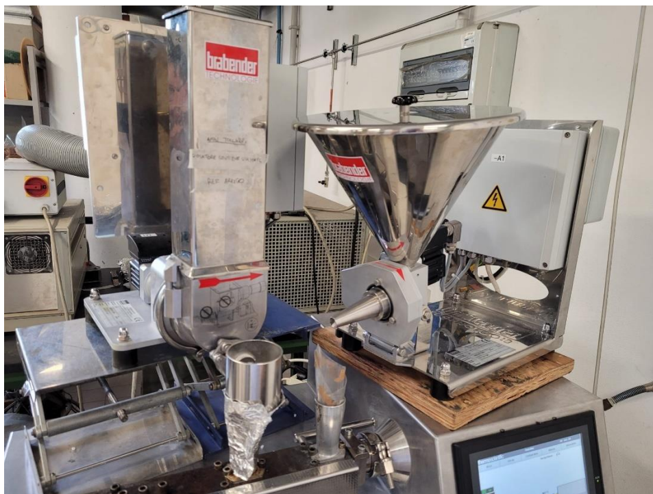
Figura 23 - a sinistra il dosatore delle polveri usato per introdurre UTEC6540, a destra il dosatore usato per introdurre i materiali della matrice (Lupolen 5021X e Eraclene MP 90 U).
