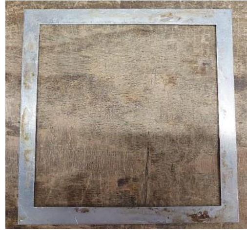
Figura 26 - Stampo 10 cm x 10 cm e spessore 1 mm [29].
