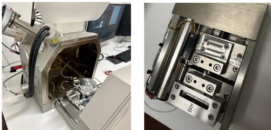
**Figura 2.7** - Sistema DEBEN MT5000 MICROTTEST 5KN.
