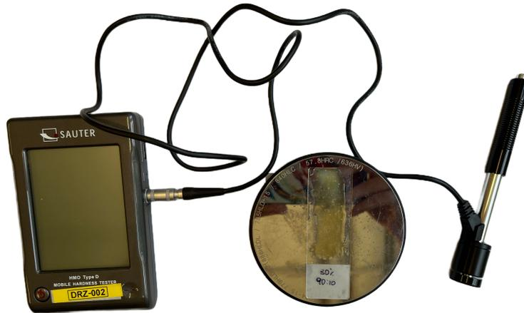
**Figura 26:** durometro HMO Leeb portatile della Sauter GmbH.
