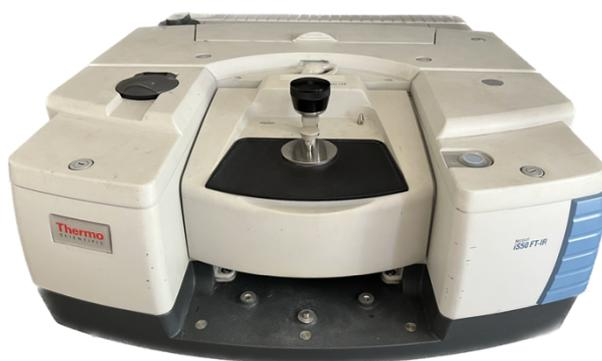
**Figura 20:** spettrometro Thermo Scientific Nicolet iS50 FT-IR in configurazione ATR.
