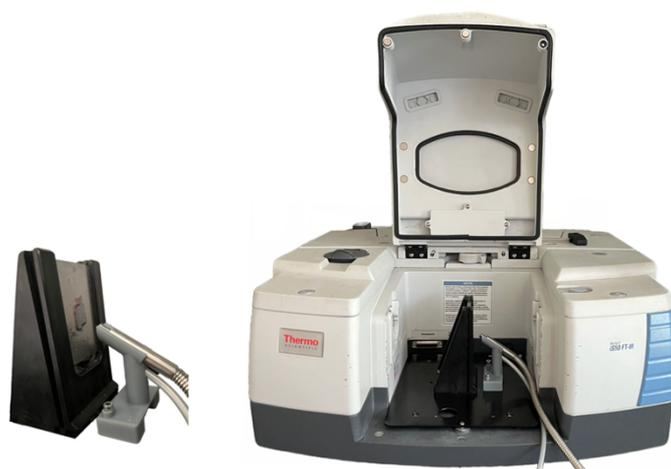
**Figura 21:** spettrometro FT-IR collegato alla lampada UV.
