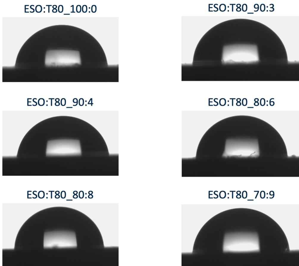
**Figura 35:** profili delle gocce depositate sull'acciaio rivestito per la misura dell'angolo di contatto.
