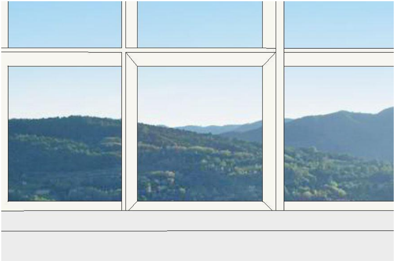
Fig. 11 - 2° Condizione: Vista prospettica, da circa 1 m dall'apertura finestrata, con punto di osservazione a 1 m di altezza dal piano di calpestio, con maglia del sistema di ombreggiamento, a cellule rettangolari 40x40cm, e profondità 30 cm
