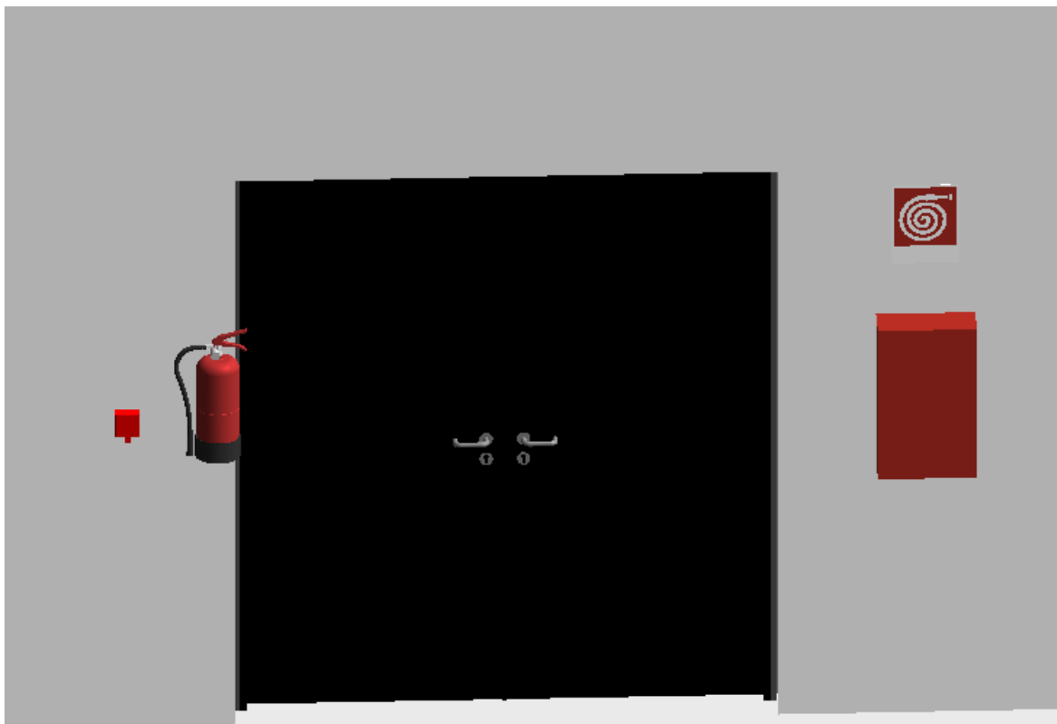
Figura 33 Estratto Revit - Disposizione sistemi antincendio U.F. _05
