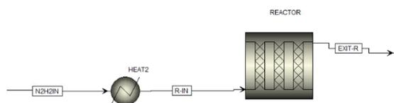
**Figura 6.10:** Schema della sezione Haber-Bosch in Aspen Plus.
