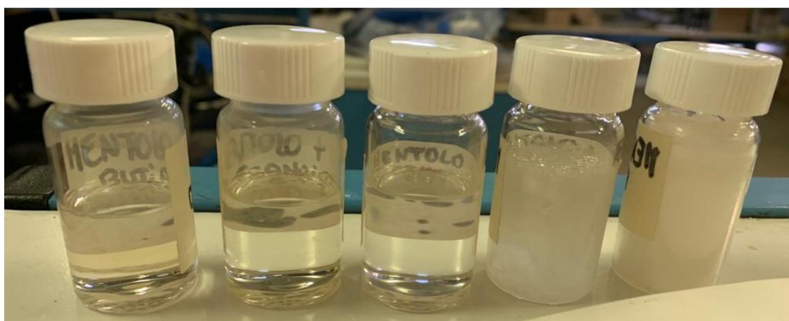
Figura 3.3 DES sintetizzati, con rapporto molare 1:1, da sinistra rispettivamente DES 1, DES 2, DES 3, DES 4 e DES 5
