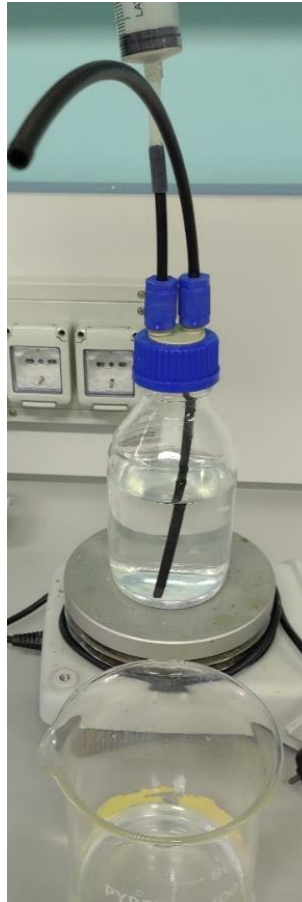
FIGURA 8 – SISTEMA DI SPIAZZAMENTO MEDIANTE SIRINGA E BECHER DI RACCOLTA ACQUA
