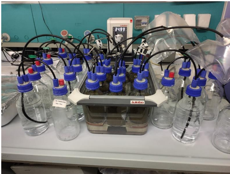
FIGURA 7 – SISTEMA INIZIALE DI SPIAZZAMENTO PER LA MISURA DELLA QUANTITÀ DI BIOGAS PRODOTTO
