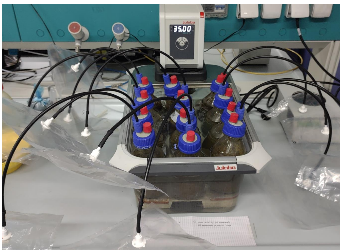
FIGURA 9 – DISPOSIZIONE DEL SISTEMA PROVA MESOFILIA
