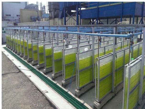
**Figura 2.6:** Fotobioreattore a piastre (flat plate) (F.G. Acién et al., 2017).
