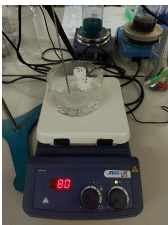
Figure 4.14: Riscaldamento della miscela eutettica per la sintesi del NaDES.
