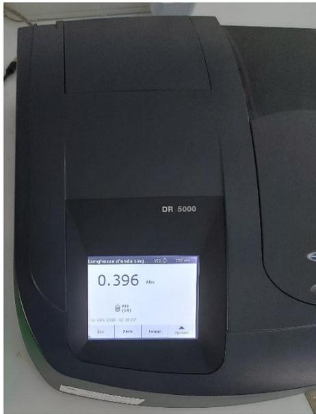
Figura 3.2: Spettrofotometro.
