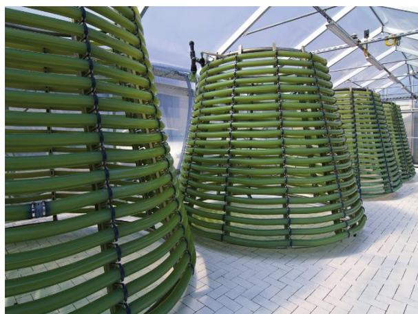
**Figura 2.8:** Fotobioreattore elicoidale a forma di troncopiramidale (gicon.de)
