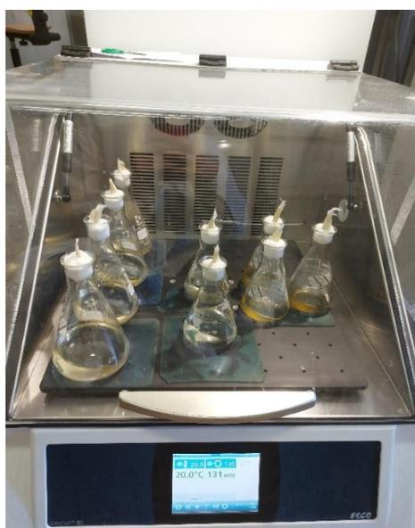
Figura 3.1: Incubatore da laboratorio utilizzato per la crescita di *P. tricornutum*
