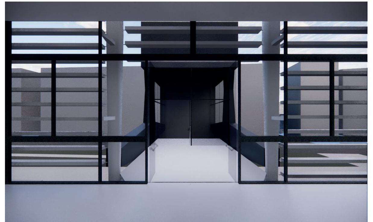
FIG 1: Vista Tridimensionale di progetto delle uscite di sicurezza ipotizzata all'interno dell'Ex Montacarichi. Si Nota che per la distribuzione delle restanti le lamelle a ridosso dell'uscita dovranno essere rimosse, come avvenuto per il Montarichi, Elaborato LP
