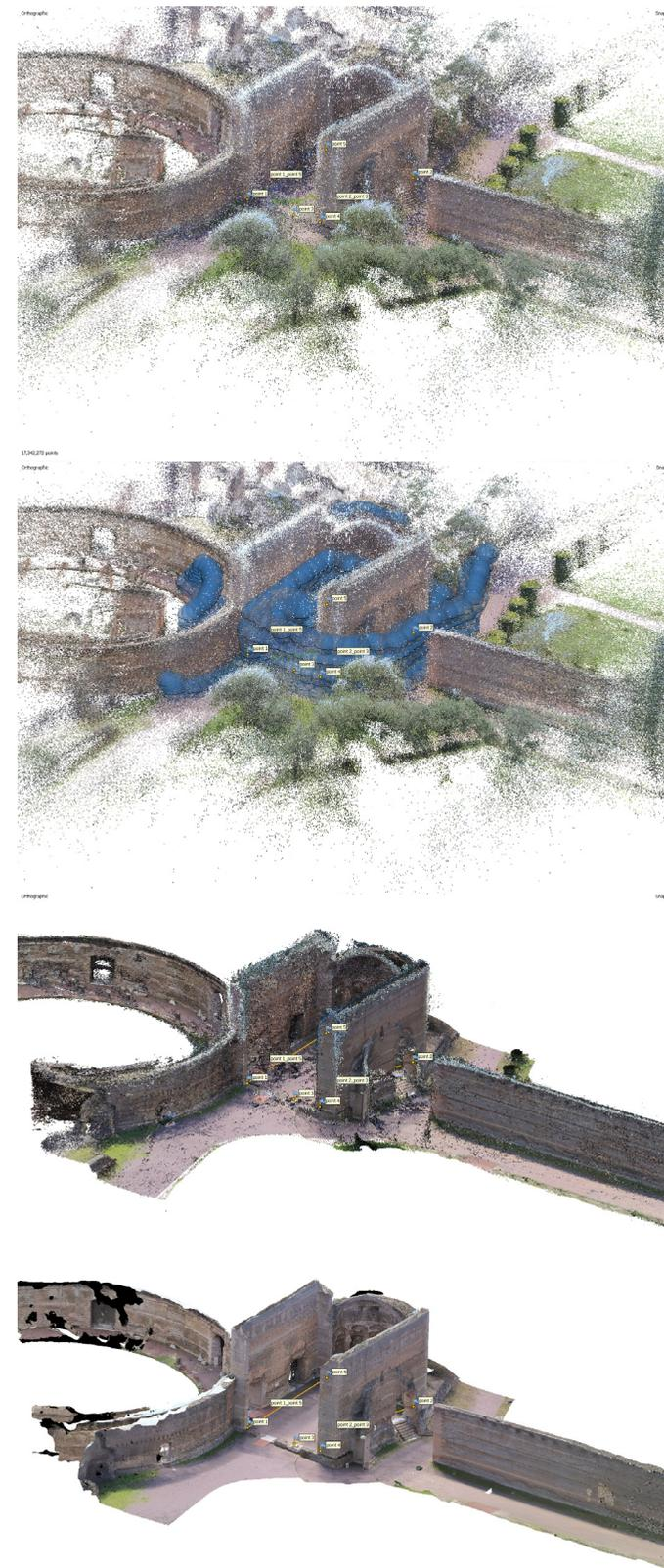
Creazione del modello tridimensionale della Sala dei Filosofi sul software MetaShape in seguito a rilievo fotogrammetrico
