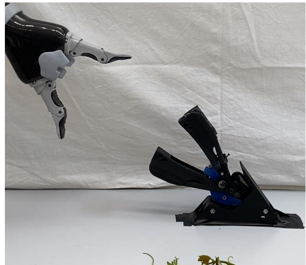
Figura 114 Sequenza di foto che illustrano il funzionamento dell'utensile sul gripper
