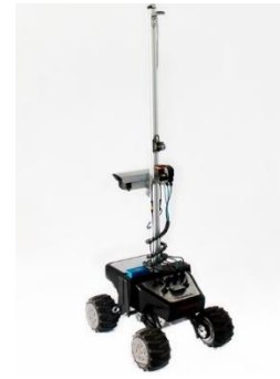
Figura 2 Esempio di robot per la raccolta dati: robot VinBot per la raccolta dati nei vigneti
