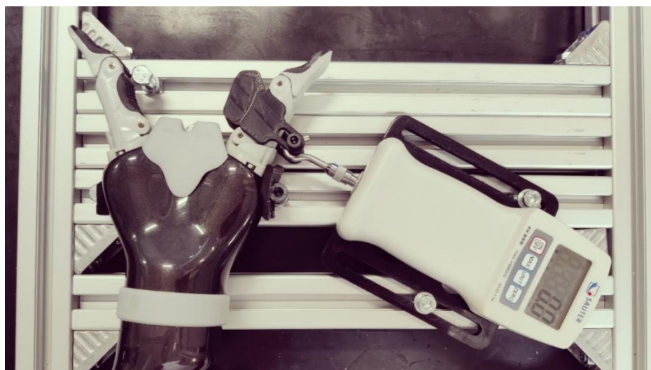
Figura 56 Foto del banco sperimentale per la valutazione della forza esplicata dalle dita del gripper con quest'ultimo a riposo, in posizione aperta
