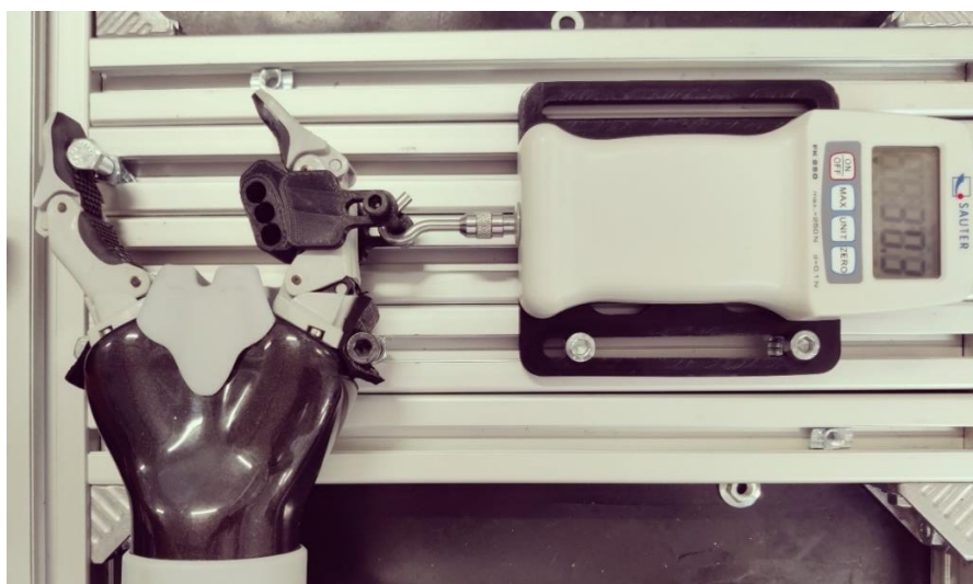
Figura 58 Foto del banco sperimentale per la valutazione della forza esplicita dalle dita del gripper in fase finale di presa, con il dinamometro che segna una forza di trazione di 30.3 N
