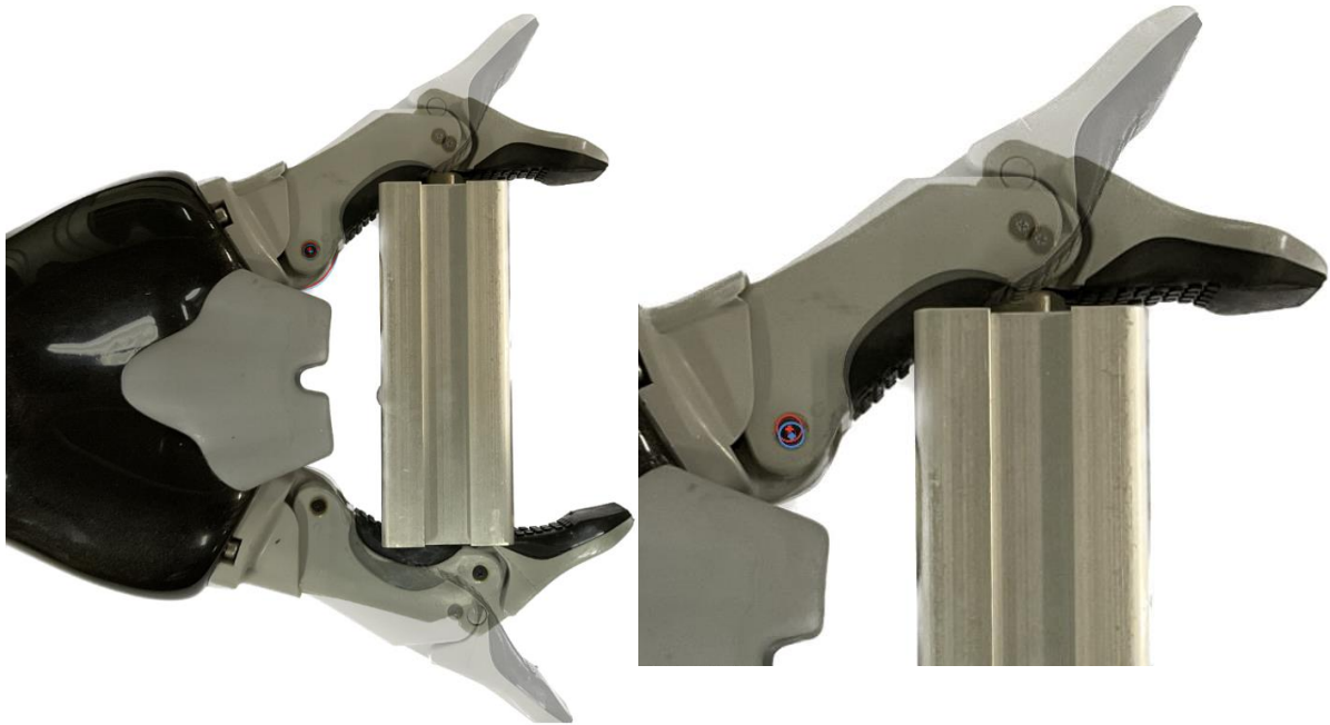
Figura 60 Presa del gripper con dettaglio sulla deformazione della cerniera fissa O
