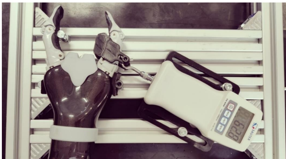
Figura 57 Foto del banco sperimentale per la valutazione della forza esplicita dalle dita del gripper in fase di presa, con il dinamometro che segna una forza di trazione di 62.8 N
