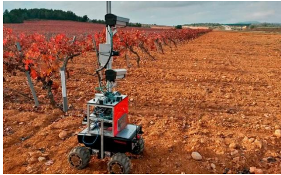
Figura 2 Esempio di robot per la raccolta dati: robot VinBot per la raccolta dati nei vigneti
