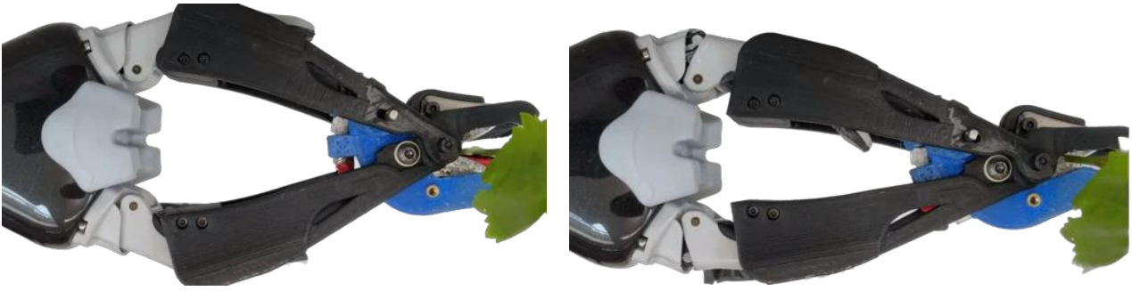
Figura 113 Sequenza di foto dedicata al taglio del campione vegetativo
