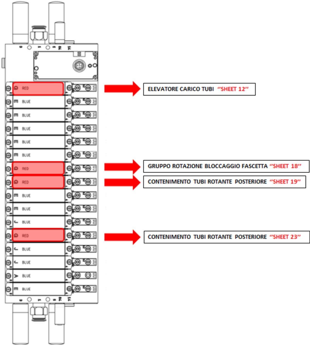
*Figure 23. Valve island schematiozation*
