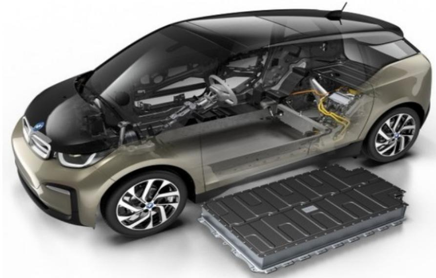
**Figura 1.4:** BMW i3 e relativo pacco batterie costituito da 12 moduli con 8 celle ciascuno (42 kWh).
