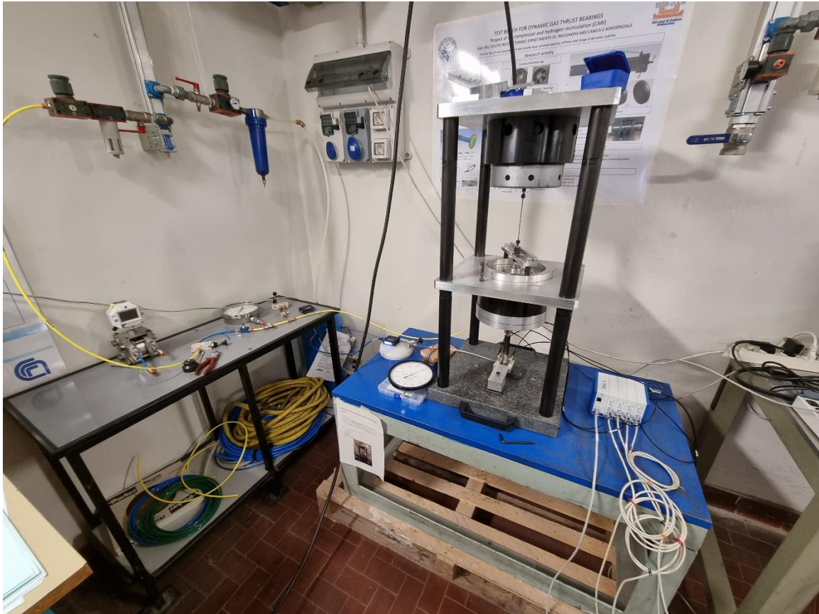
Figura 2.13: Fotografia del banco prova cuscinetti.
