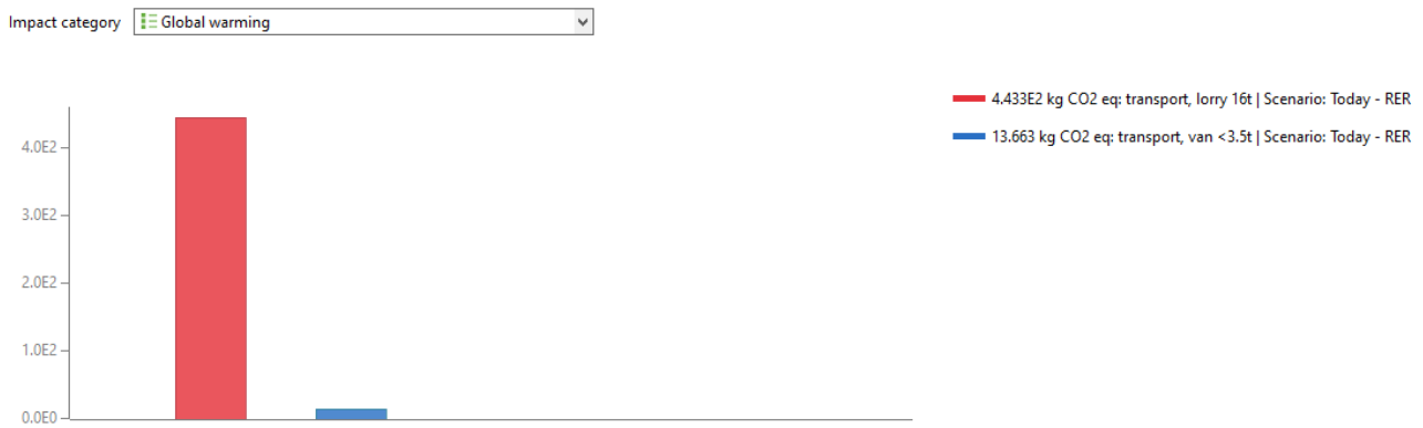
Figura 29- Analisi di impatto ambiente di un van e di un lorry 16t ottenuto con OpenLCA per eseguire il confronto dei risultati con quelli ottenuti nella metodologia implementata su Excel
