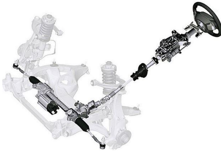
Figura 15- Sottosistema sterzo di un'automobile [48]
