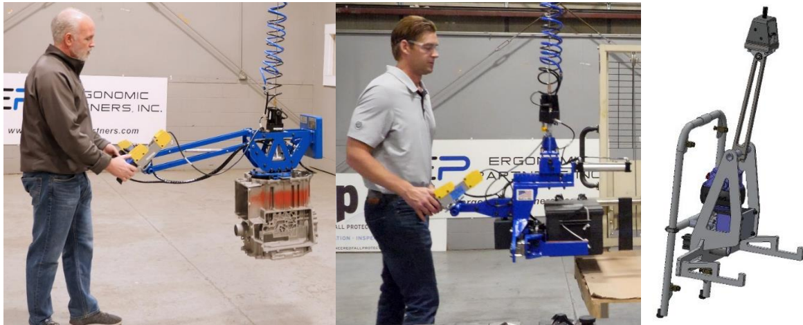
Figura 3.1: Immagini ritraenti tre dispositivi atti al sollevamento di tipologie diverse di carico. È possibile riconoscere degli elementi in comune come un telaio con le superfici di aggancio, elementi di presa e controllo da parte dell'operatore per rendere il dispositivo più ergonomico 3 .
