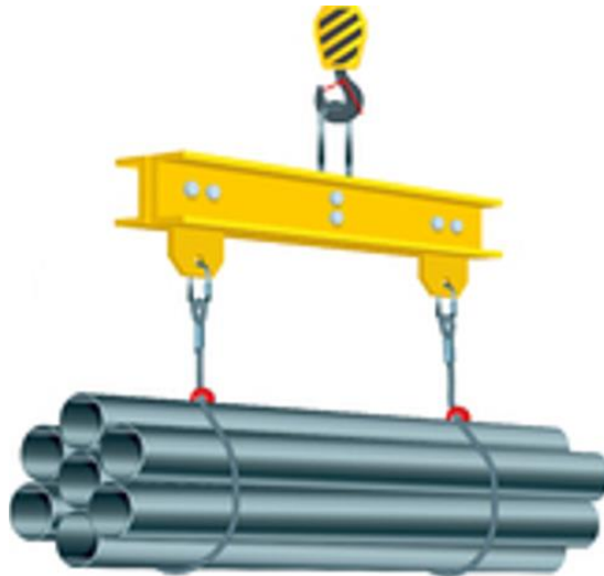
Figura 6.72: L'impiego di una traversa permetterebbe di evitare di avere delle imbracature inclinate che interferiscono con le guide.
