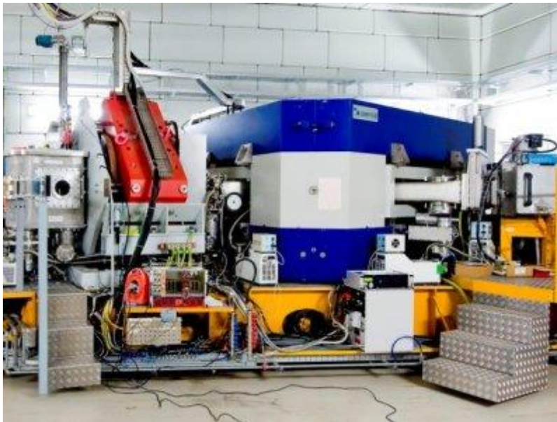
Figura 1.3: Foto dello spettrometro MAGNEX dove si possono notare, da sinistra, il quadrupolo in rosso ed il dipolo in blu 2 .
