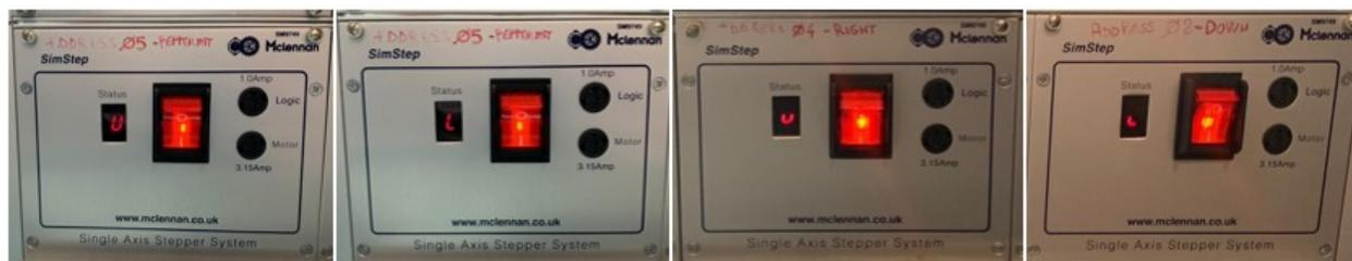
Figura 3.4: I segnali di raggiungimento del finecorsa.
