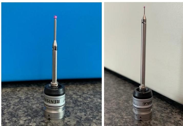
(a) Sonda 1x10 con estensione di 10 mm.      (b) Sonda 1x20.
