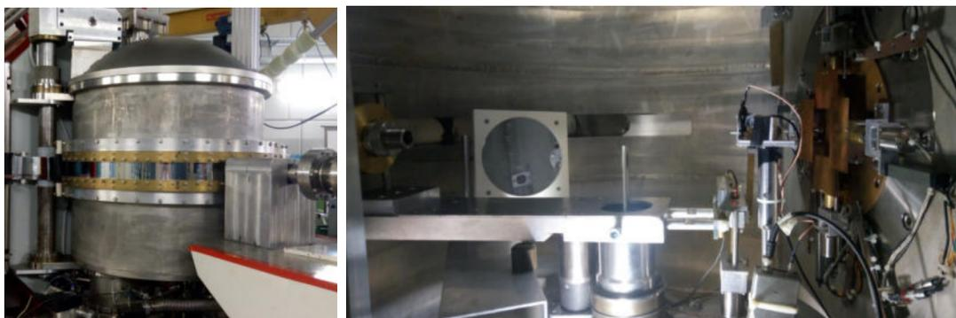
(a) Camera di scattering pre-esistente [15].      (b) Interno della vecchia camera di scattering [15].
