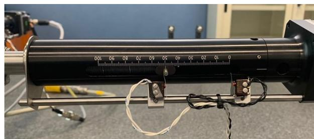
Figura 2.13: I finecorsa installati sull'attuatore.
