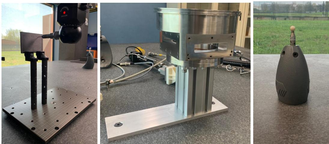
(a) I fissaggi modulari. (b) Il supporto utilizzato per sollevare e (c) La sfera per la
