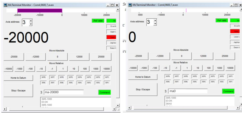
(a) Comando che impone uno spostamento di 20000 steps al motore associato all’indirizzo 03 (slitta LEFT). (b) Comando che impone uno spostamento di 0 steps al motore associato all’indirizzo 03 (slitta LEFT).
