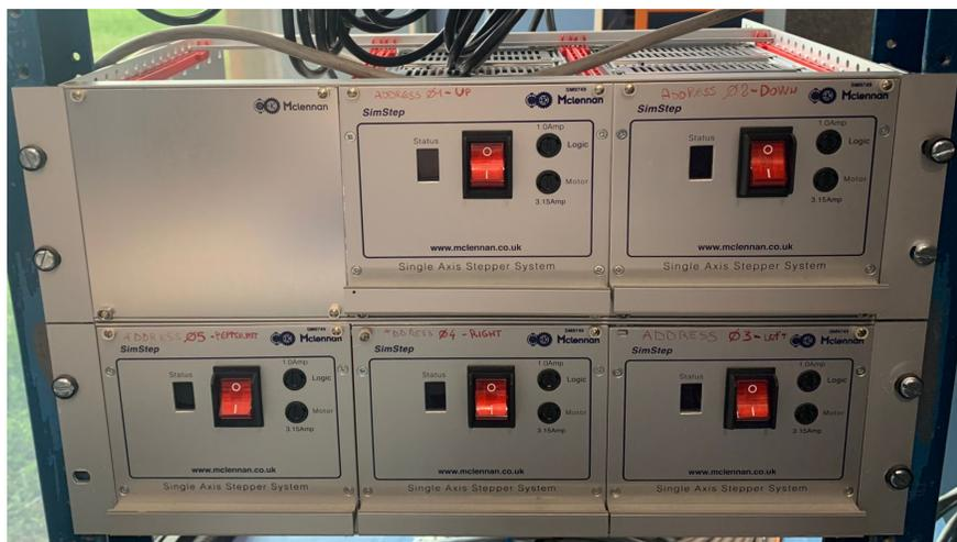
Figura 3.1: Le cinque unità di controllo che permettono la movimentazione dei motori del sistema.
