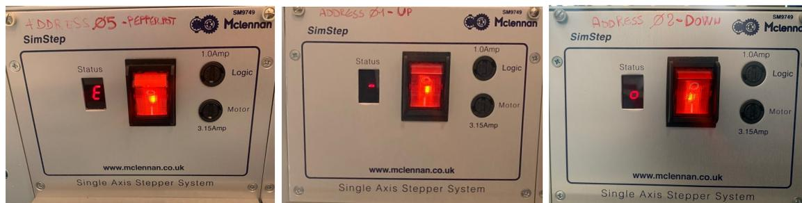
(a) Segnale di errore. (b) Segnale di assenza guasti. (c) Segnale di movimentazione in corso del motore.
