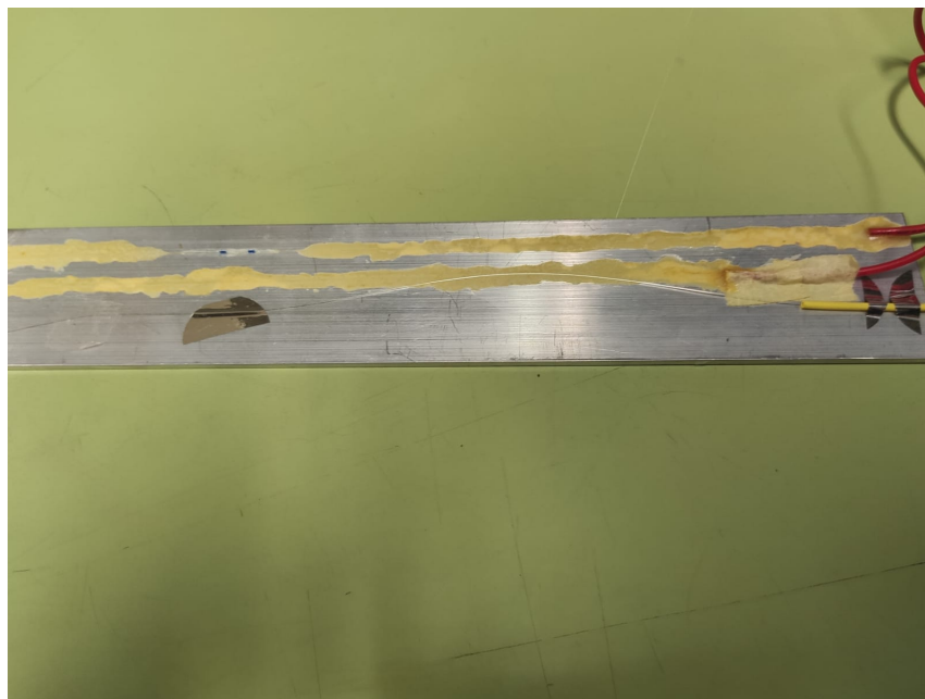
Figura 3.1: Provino in lega di alluminio
