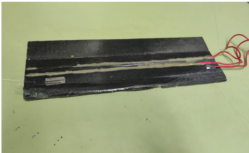
Figura 3.2: Provino in composito in fibra di carbonio
