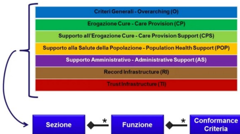
Figura 2.1: Struttura di un EHR secondo lo standard ISO/HL7 10781 EHR-S FM. [28]
