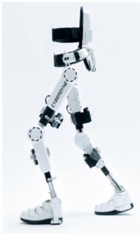
Figure 2.3: HAL exoskeleton.
